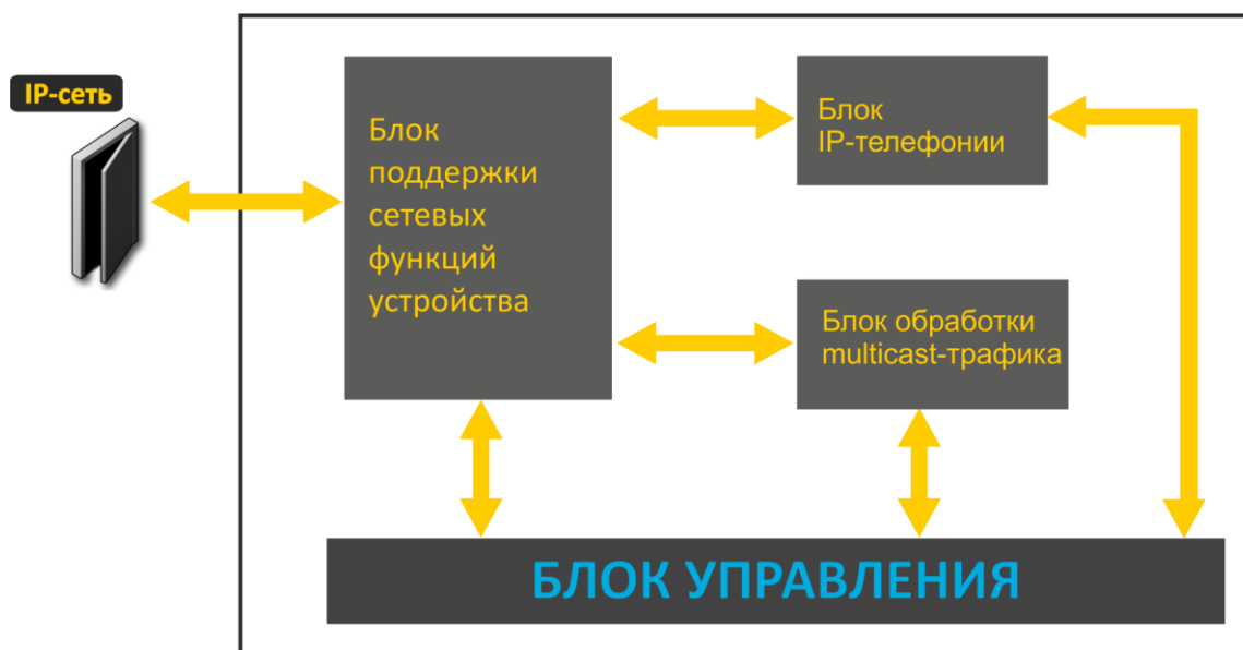
Рисунок 3 – Функциональная схема устройства серии RG-5421G-Wac
